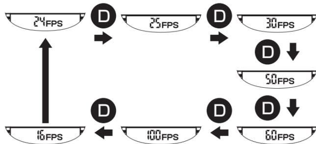
FPS 切り替え / ラップ / スプリットモード表示のときに、D ボタンを押して「FPS」を切り替えます。
